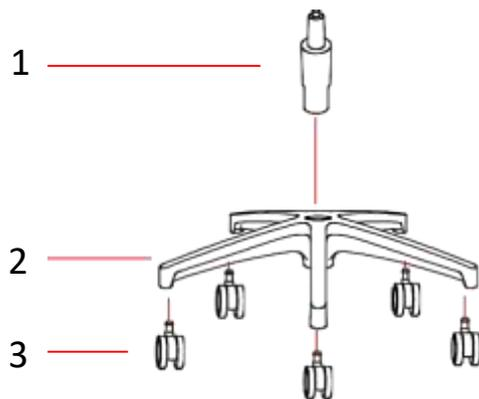
Paso 1: Unir las ruedas a presión y coloque el pistón sobre la base estrella.
