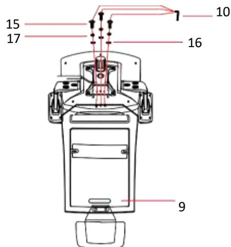
Paso 5: Utilizando la llave Ale, una el respaldar al asiento de la silla utilizando los tornillos M8X45MM junto con 3 arandelas M6X17MM y 3 arandelas M8x13MM. Luego agregue el elemento decorativo para ocultar los tornillos del reposacabezas.
