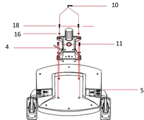
Paso 3: Utilizando la llave Ale, fije la base del asiento. En la parte delantera utilice los tornillos M6x40MM y 2 arandelas M6x17MM. En la parte trasera utilice los tornillos M6X35MM y 2 arandelas M6x17MM.
