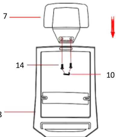
Paso 4: Fije el reposacabeza al respaldar de la silla utilizando los tornillos M6 X M16.
