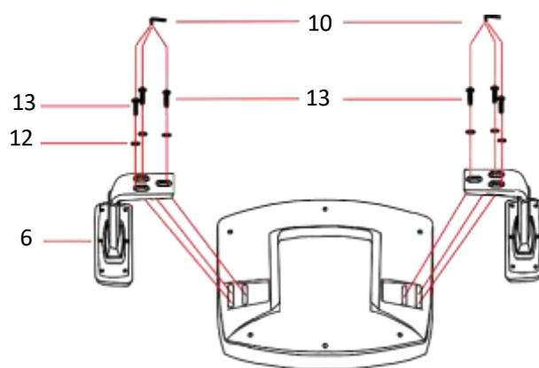
Paso 2: Utilizando la llave Ale, fije los reposabrazos al asiento con las 6 arandelas M6X15MM y los 6 tornillos M6x45MM.
